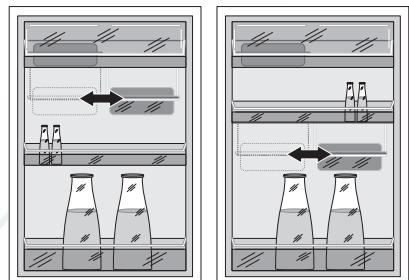
2. При установке полки на другую высоту, пожалуйста, проделайте вышеописанную процедуру в обратном порядке. Передвижную коробку можно также подвесить сбоку на одной из полок холодильного помещения:
