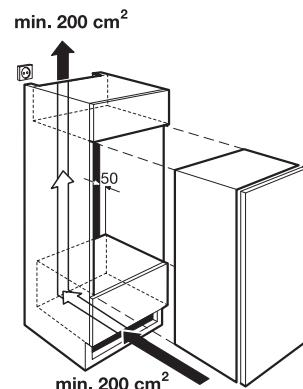
**Внимание!** Чтобы не нарушать нормального функционирования прибора, эти вентиляционные отверстия нельзя прикрывать или чем-либо заставлять.
